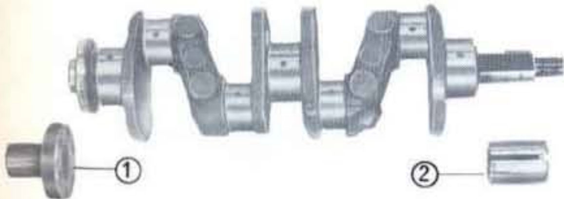
Sl. 57. — Radilica i alat za pričvršćivanje na brusilicu. 1. i 2. Prirubnica i čaura alata A.60080.
