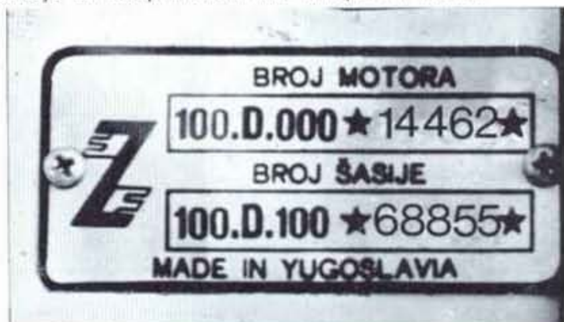
Sl. 5. — Tablica sa brojevima za identifikaciju vozila.
