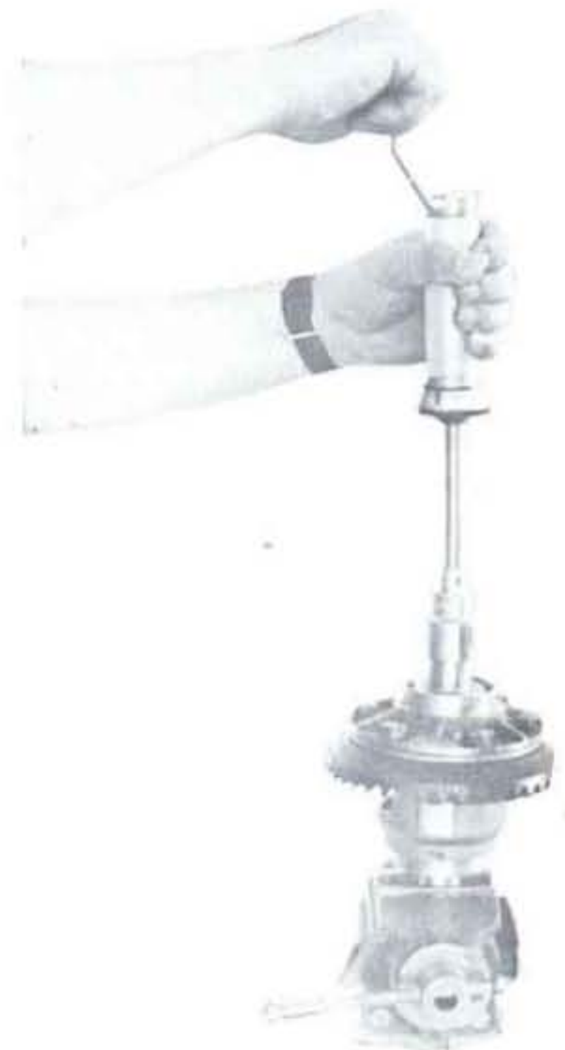
Sl. 218. — Provera momenta okretanja planetarnog zupčanika.
