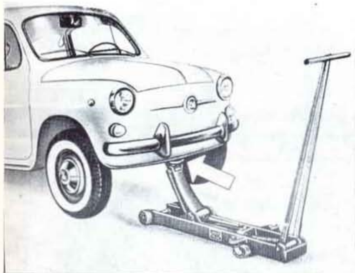
Sl. 6. — Podizanje prednjeg dela vozila pomoću pokretne hidraulične dizalice D 10051. Šapa dizalice postavljena je ispod naročite ploče za podizanje vozila.
