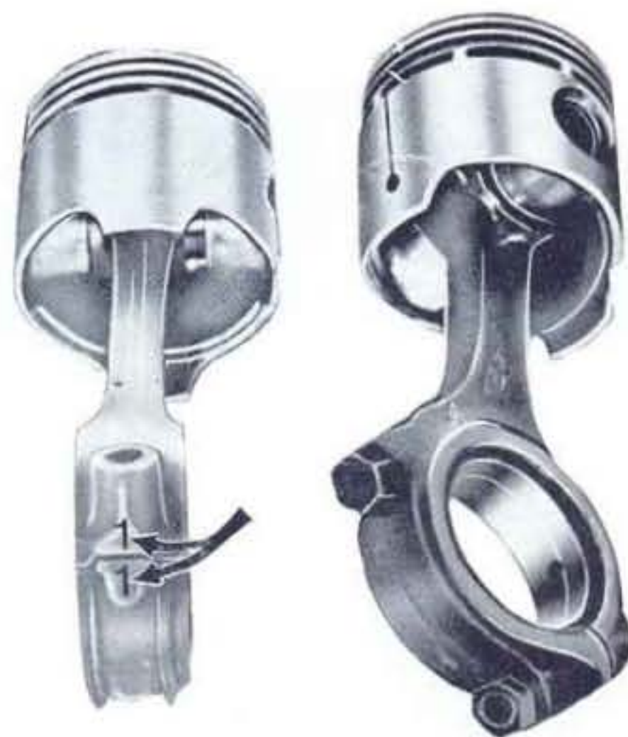
Sl. 48. — Obeležavanje sklopa klipnjača — klip. Položaj ekspanzionog proreza na klipu u odnosu na broj klipnjače. Strelice pokazuju oznake klipnjače.
