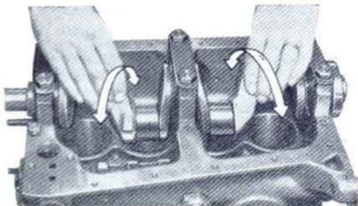
Sl. 74. — Kontrola okretaja radilice kada su namešteni svi poluležajevi glavnih rukavaca.
