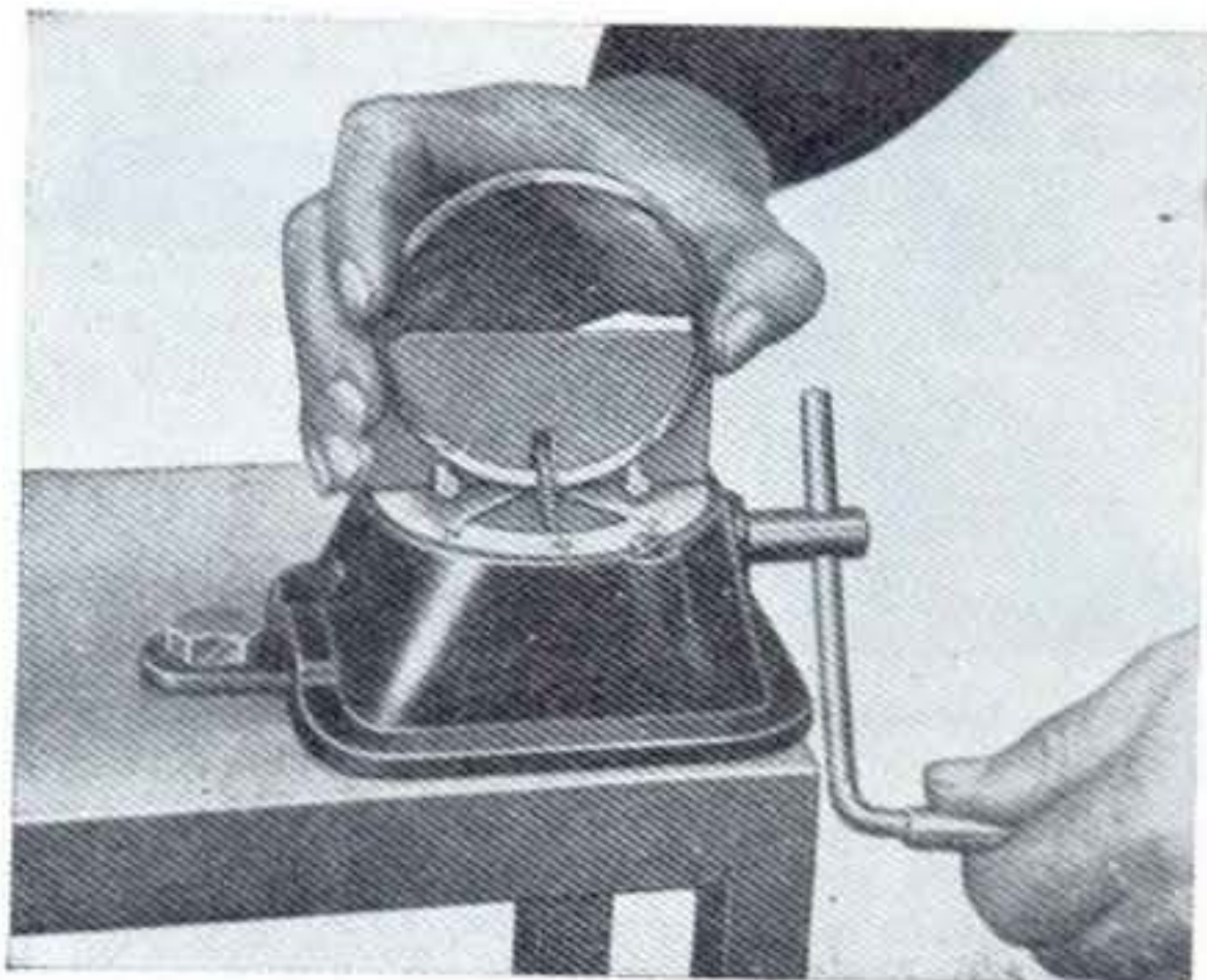
Sl. 35. — Obrada krajeva klipnih prstenova pomoću alata A.60188.
