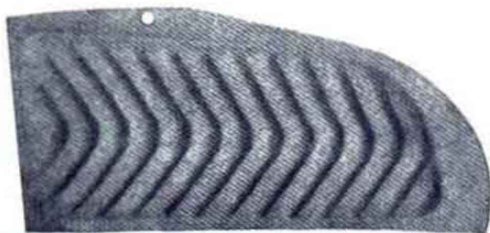
Sl. 338. — Prečistač vazduha za zagrevanje unutrašnjosti vozila.
