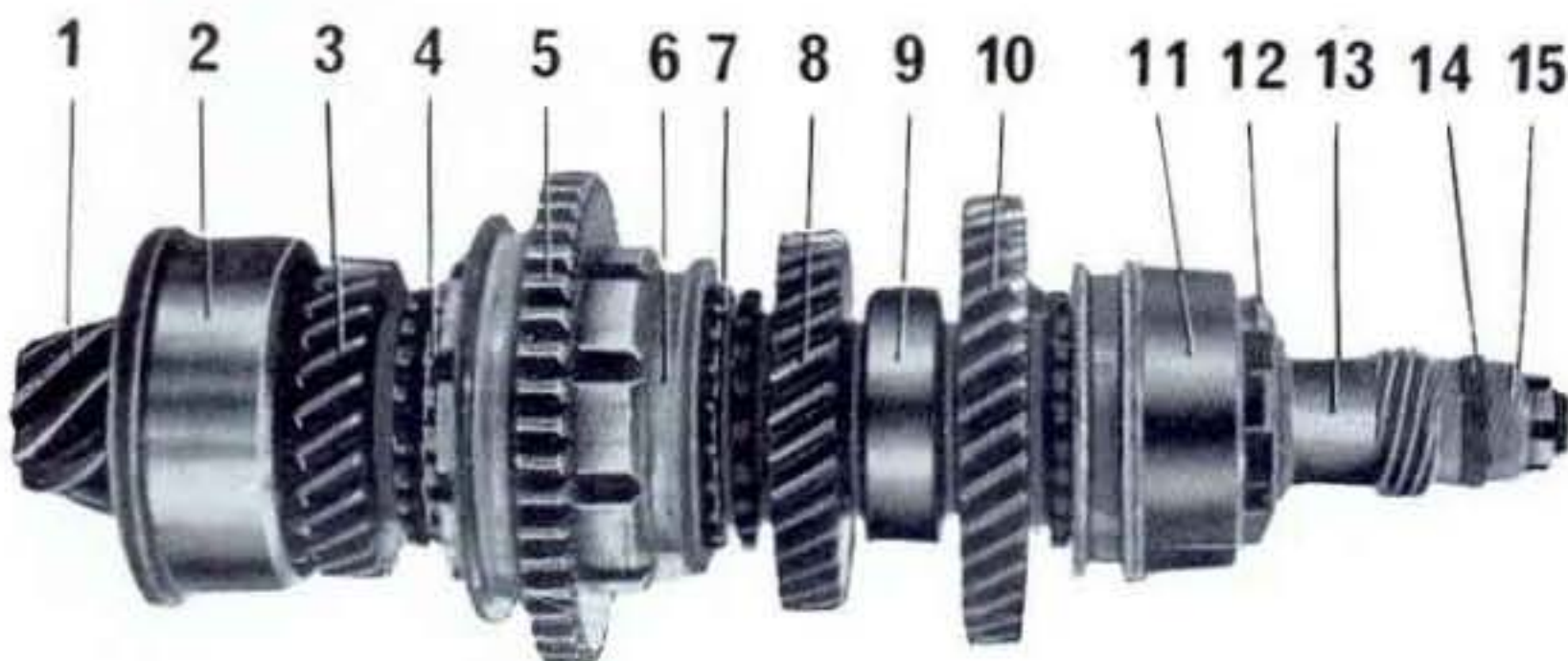
1. Pomoćna osovina — glavasti zupčanik. — 2. Zadnji kuglični ležaj. — 3. Zupčanik 4-tog stepena prenosa. — 4. Sinhroni prsten za uključivanje 4-tog stepena prenosa. — 5. Pomični zupčanik 1-vog stepena prenosa i hoda unazad. — 6. Kandžasta spojka za uključivanje 3-ćeg i 4-tog stepena prenosa. — 8. Zupčanik 3-ćeg stepena prenosa. — 9. Srednji kuglični ležaj. — 10. Zupčanik 2-gog stepena prenosa. — 11. Kandžasta spojka za uključivanje 2-gog stepena prenosa. — 12. Elastične kandžaste spojke za uključivanje 2-gog stepena prenosa. — 13. Vodeći zupčanik komande brojača kilometara. — 14. Podmetač. — 15. Navrtka.
