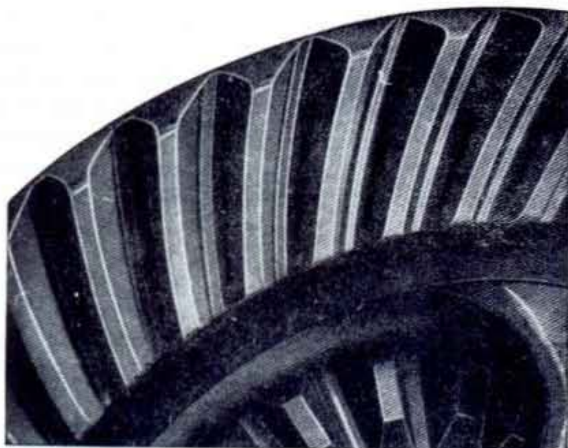
Sl. 224. — Kontakt pretežno na korenu zuba. Glavasti zupčanik treba udaljiti od tanjirastog zupčanika smanjenjem debljine prstena za podešavanje.
