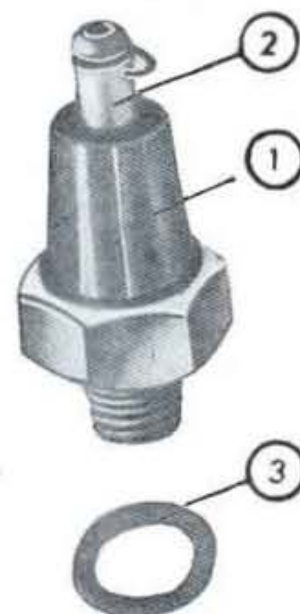
Sl. 161. Prekidač nedovoljnog pritiska ulja za podmazivanje motora.
