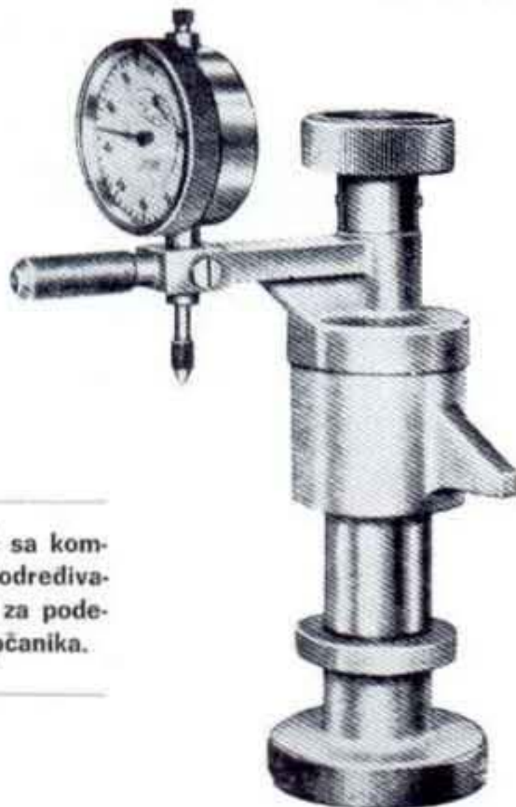
Sl. 212. — Postavljanje alata A.70026 na zadnji ležaj glavastog zupčanika.
