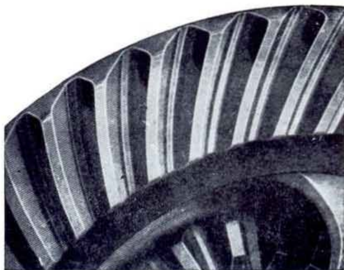
Sl. 227. — Kontakt pretežno na kraju zuba. Glavasti zupčanik treba udaljiti od tanjirastog smanjenjem debljine prstena postavljenog između glavastog zupčanika i zadnjeg ležaja.
