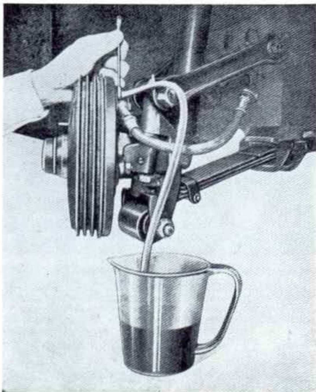
Sl. 327. — Ispuštanje vazduha iz kočionog cilindra prednjeg levog točka uz upotrebu gumene cevčice A. 72206.
