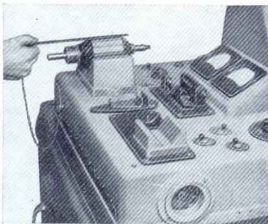
Sl. 351. — Proba rotora dinamama na aparatu za probu rotora sa lamelom. U blizini namotaja u kratkom spoju lamela će početi da vibrira.
