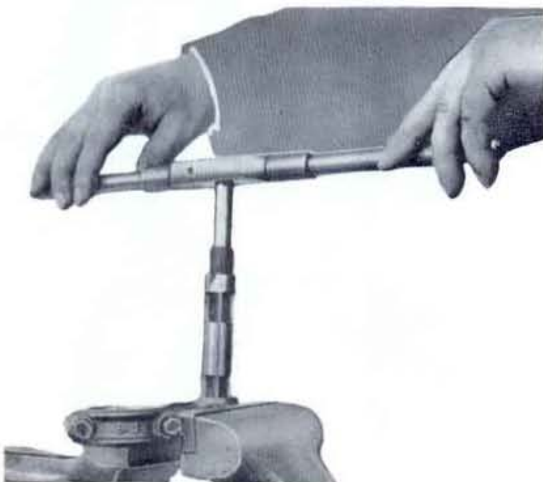
Sl. 51. — Obrada čaure osovince klipa, pomoću podešljivog razvrtača A. 90307.
