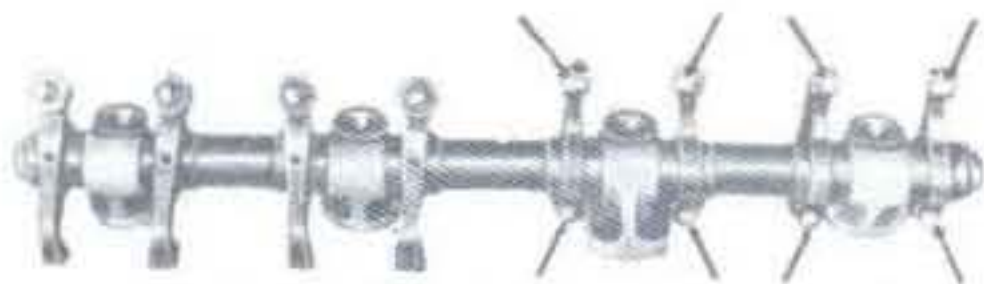
Sl. 117. — Sklop klackalica sa osovinom i nosačima.
