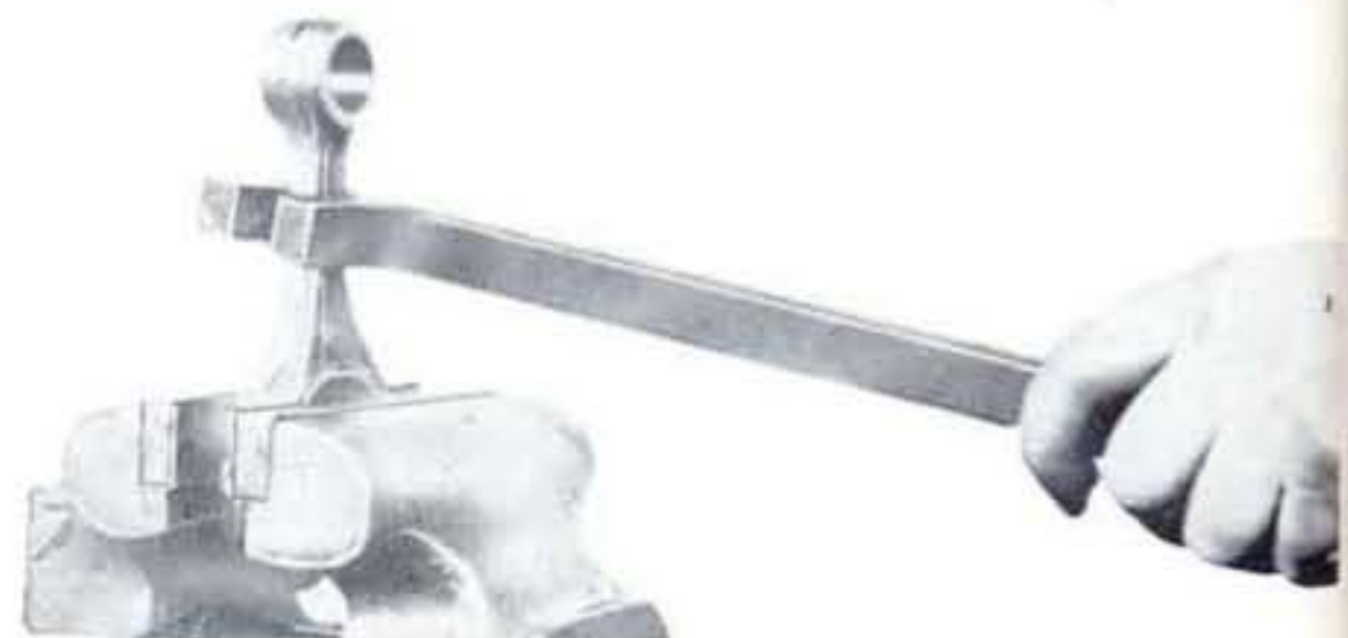
Sl. 53. — Ispravljanje klipnjače specijalnom polugom A.60183
