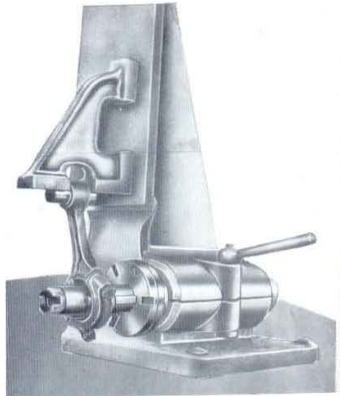
Sl. 52. — Kontrola paralelnosti osa male i velike pesnice klipnjača na alatu Ap. 5051.
