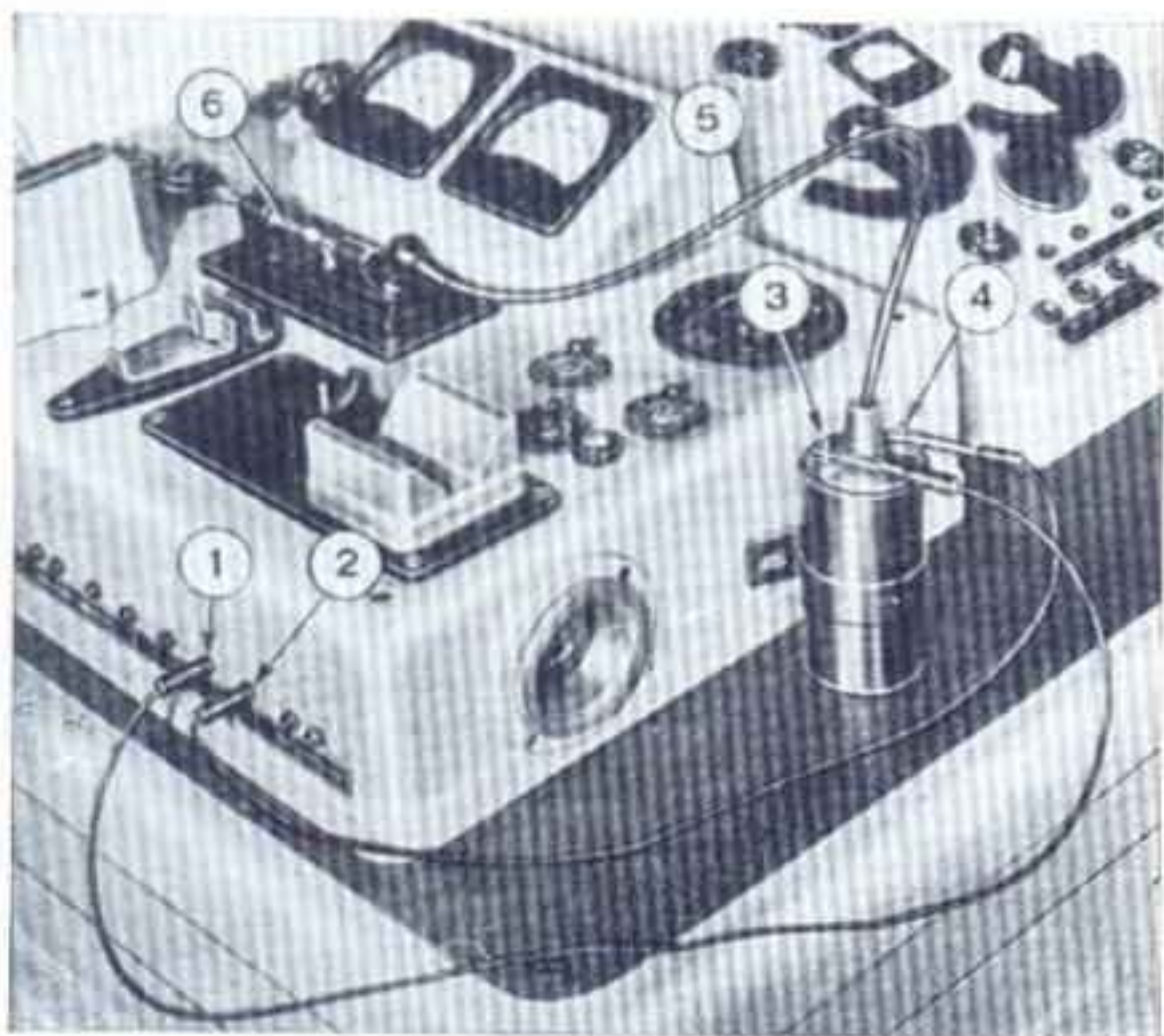
Sl. 389. — Proba indukcionog kalema na probnom stolu za električne agregate.
