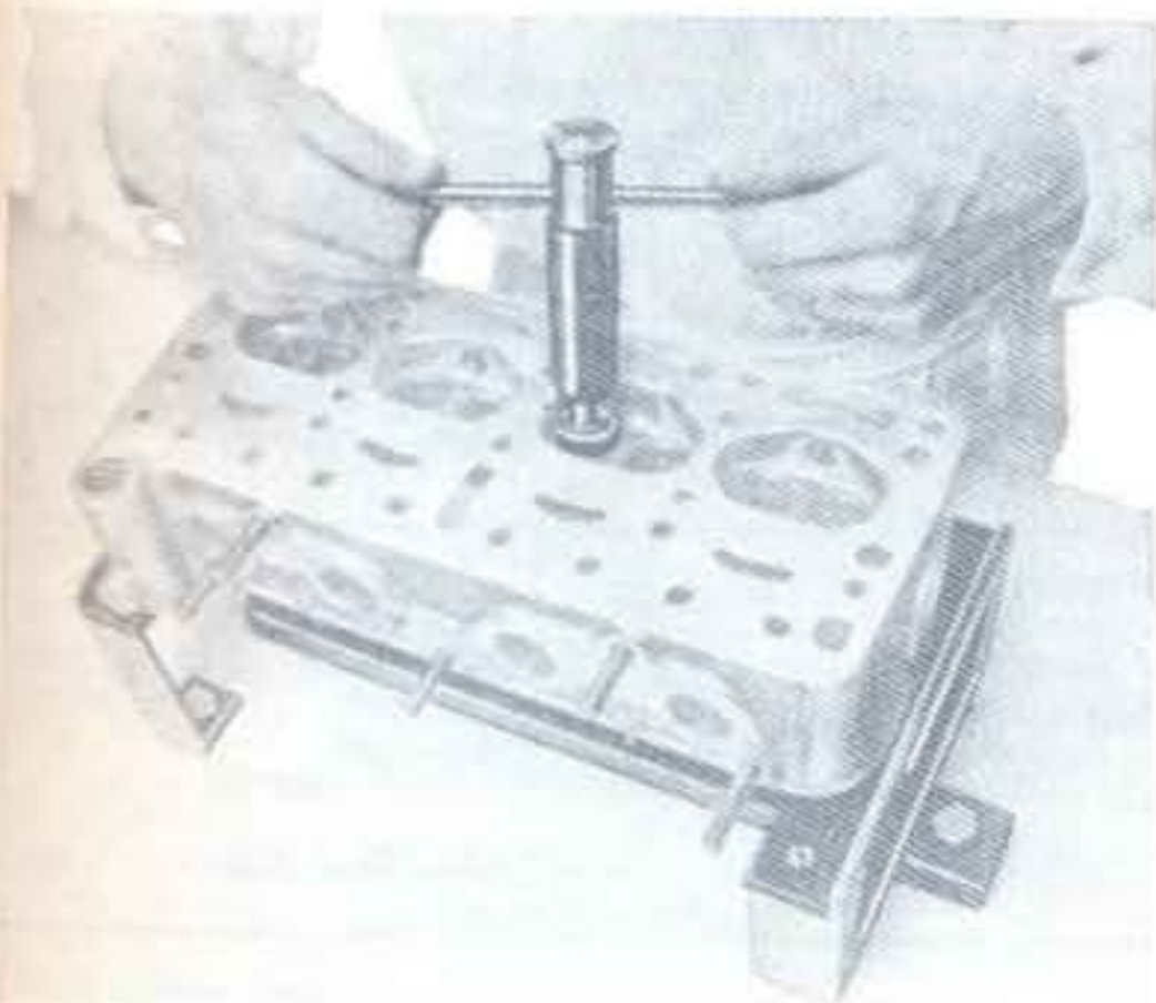
Sl. 92. — Smanjenje širine sedišta ventila pomoću glodača A. 94030 (75°) postavljenog na nosač A. 94058.
