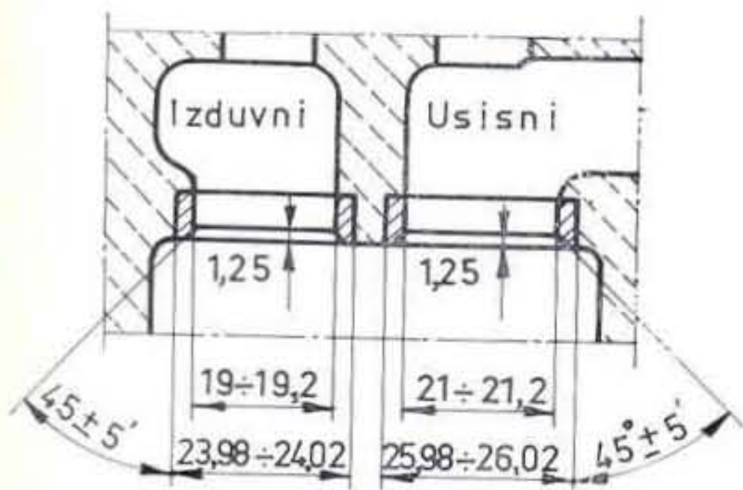
Sl. 100. — Glavni podaci sedišta na glavi cilindra za usisne i izduvne ventile.
