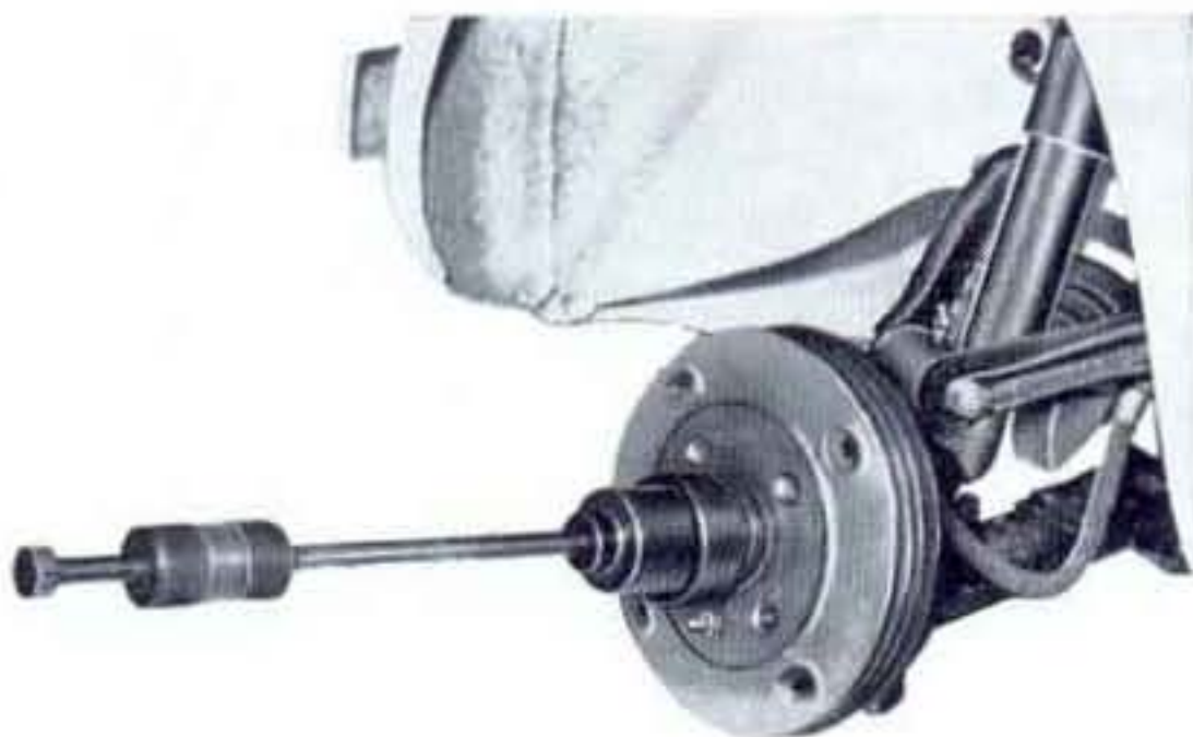
Sl. 256. — Skidanje poklopca glavčine prednjeg točka, pomoću izvlačača A. 47014.
