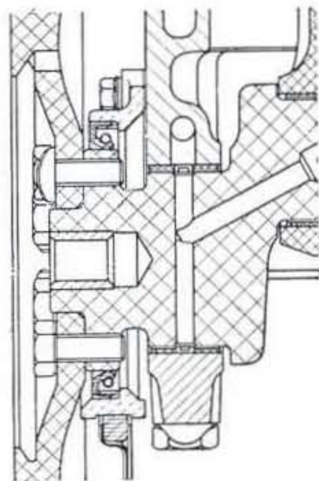
Sl. 79. Detalj uzdužnog preseka motora kroz zaptivač i čauru spojničke osovine.
