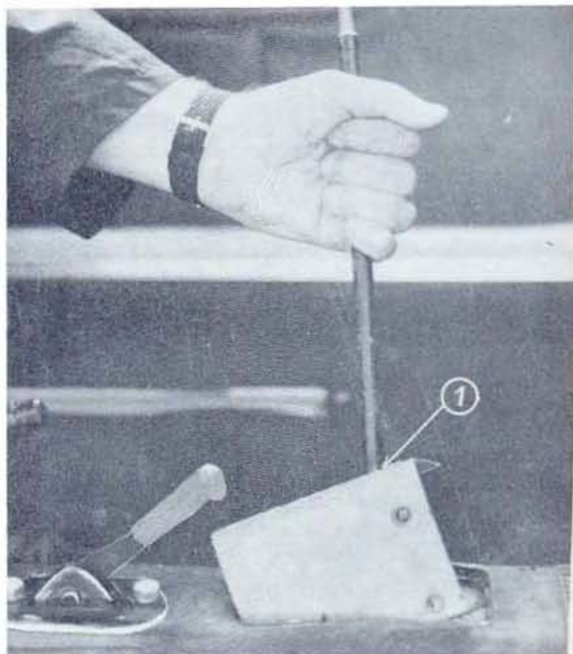
Sl. 235. — Izgradivanje sklopa komande za promenu stepena prenosa.
