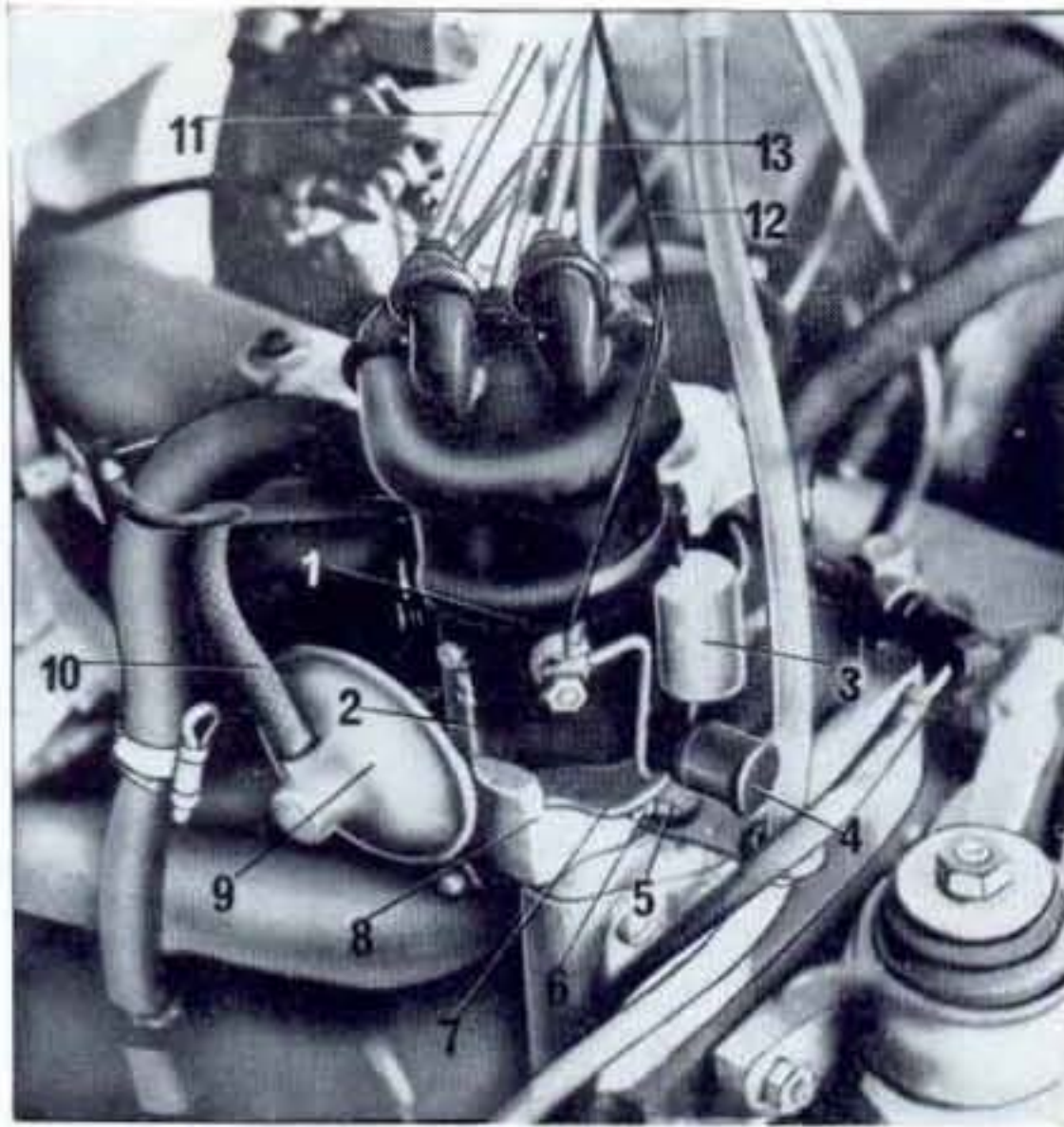
Sl. 386. — Razvodnik paljenja sa depresionim ispravljačem pretpaljenja na motoru.
