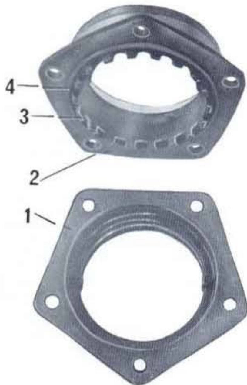
Si. 206. — Sklop kutije za nošenje konusno-valjčastog ležaja diferencijala.
