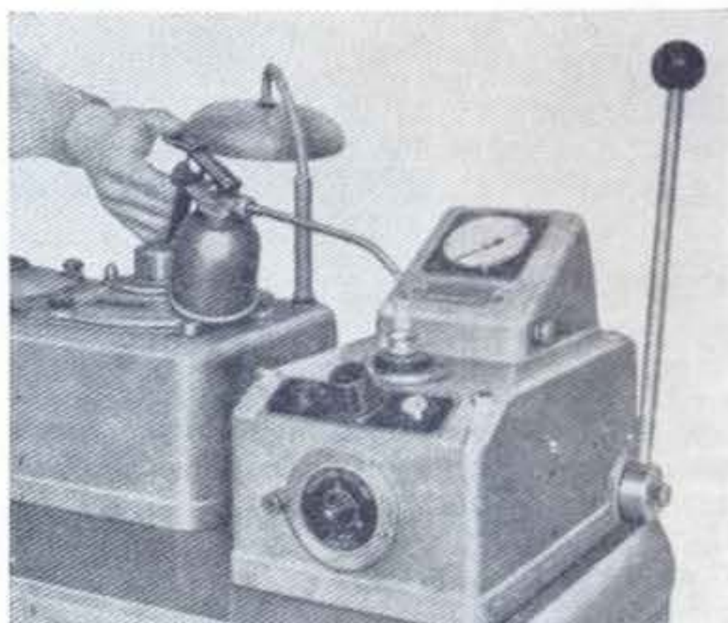
Sl. 392. — Proba zaptivnosti svećica.
