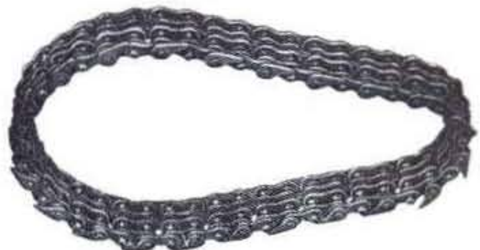
Sl. 121. — Dvoredni lanac za pogon mehanizma razvoda.
