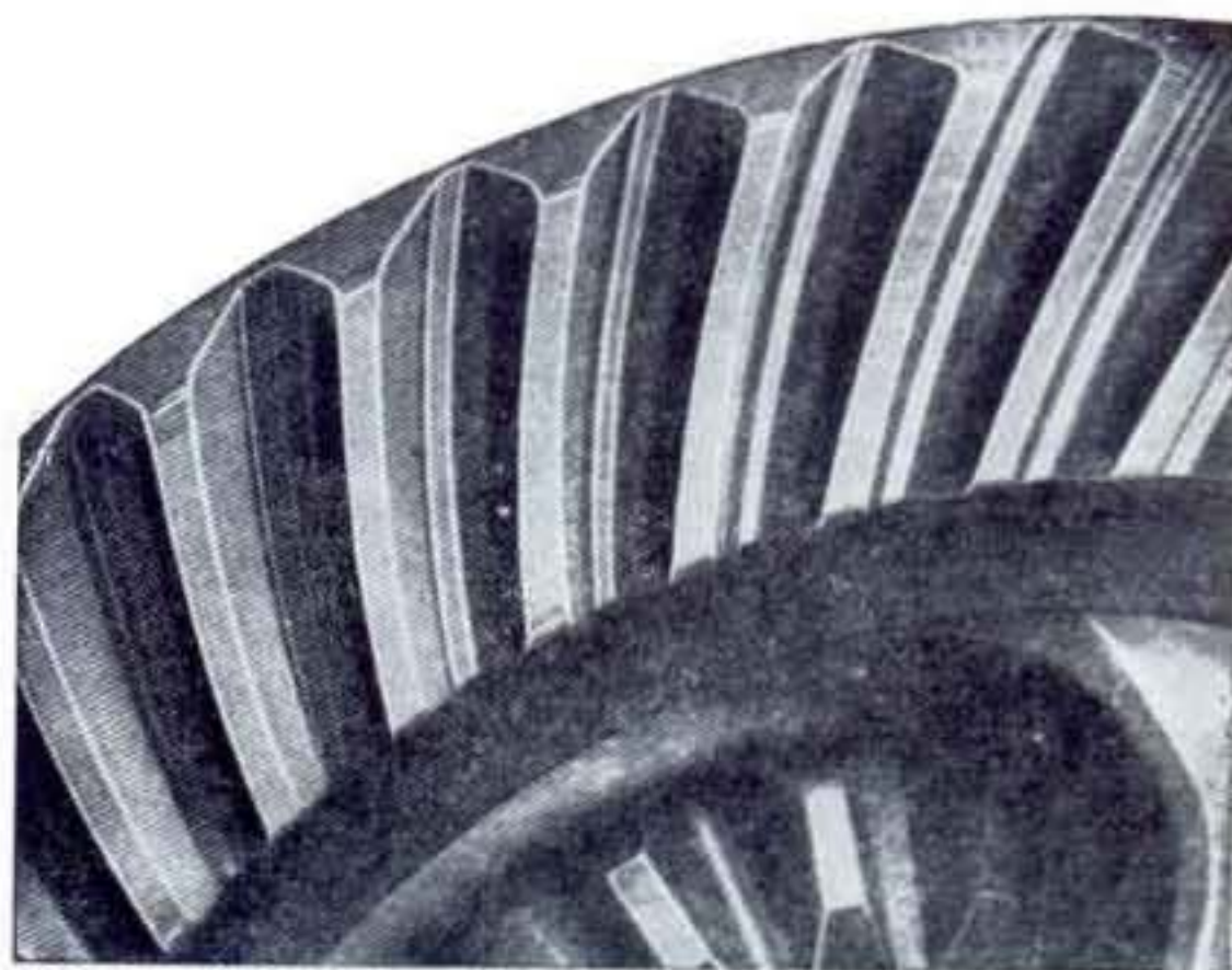
Sl. 226. — Kontakt pretežno na ivici zuba. Glavasti zupčanik treba približiti tanjirastom povećanjem debljine prstena za podešavanje.
