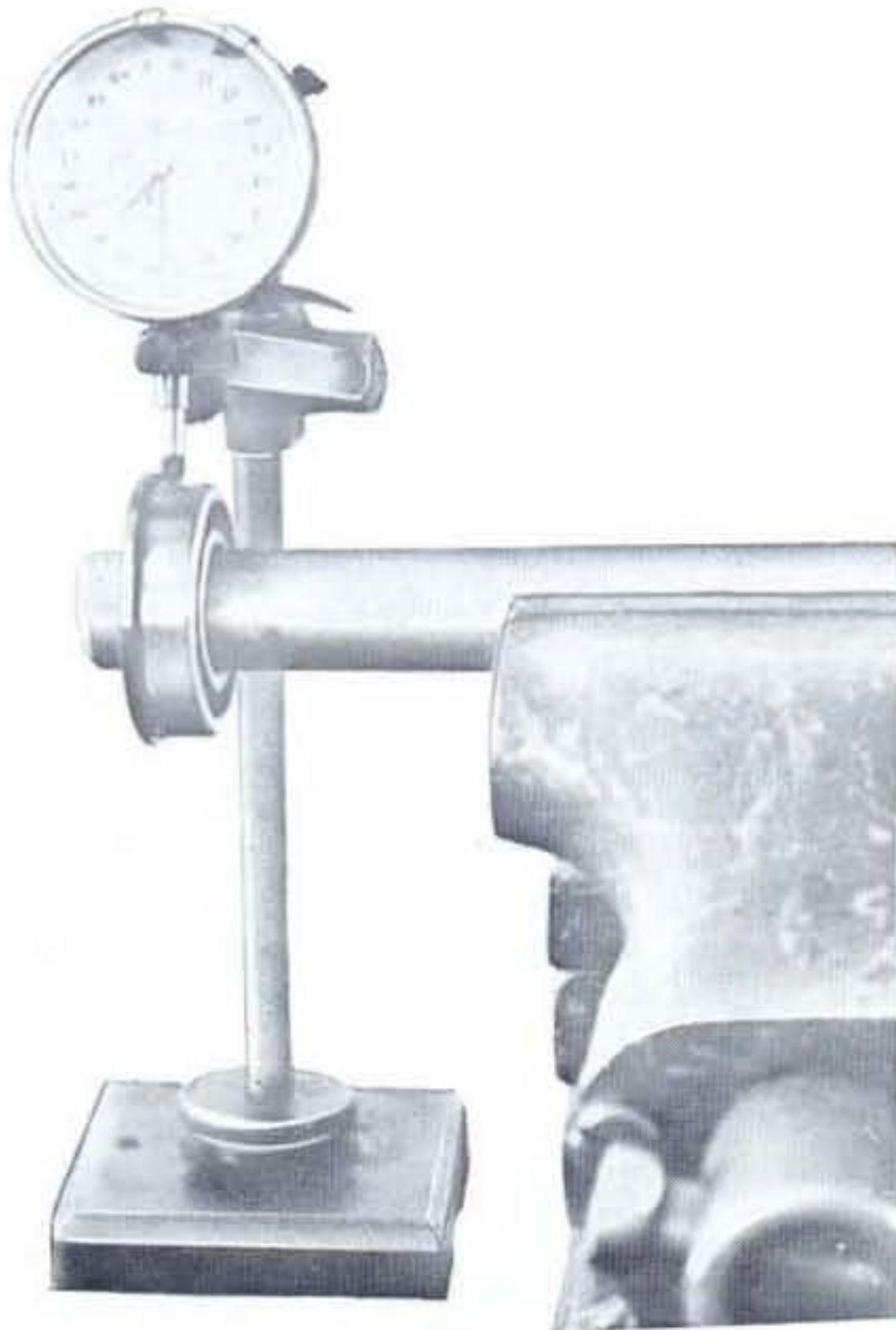
Sl. 194. — Kontrola radijalnog zazora zadnjeg kugličnog ležaja glavne osovine (maksimalno dopušten zazor 0,05 mm).
