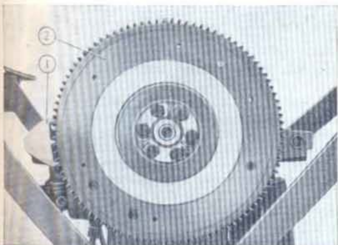
Sl. 17. — Postavljanje alata A.60282 za držanje zamajca pri odvijanju vijaka za pričvršćivanje zamajca.
