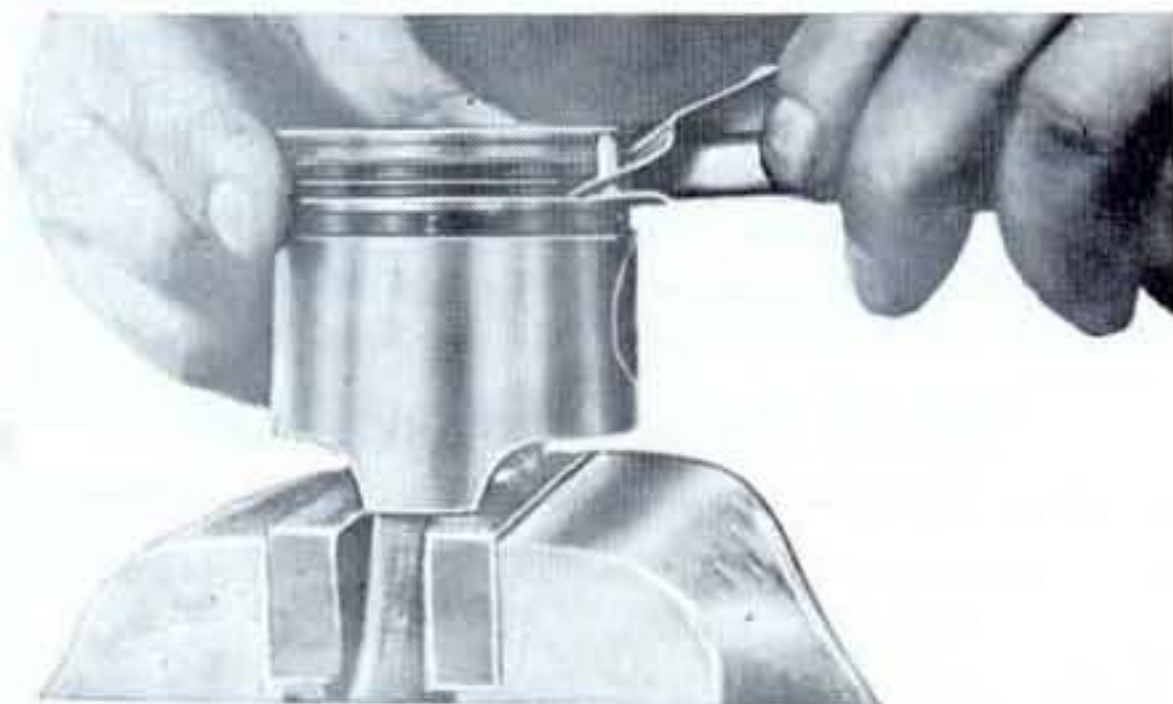
Sl. 38. — Nameštanje klipnih prstenova na klip pomoću klešta A.60182
